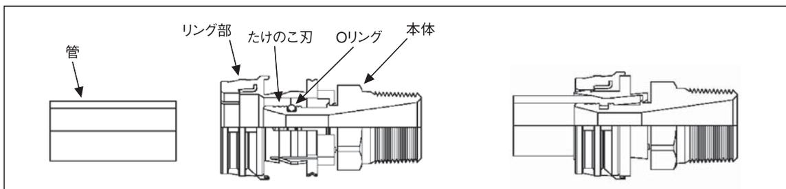
図Ⅱ-2-3 スライド継手による接合
