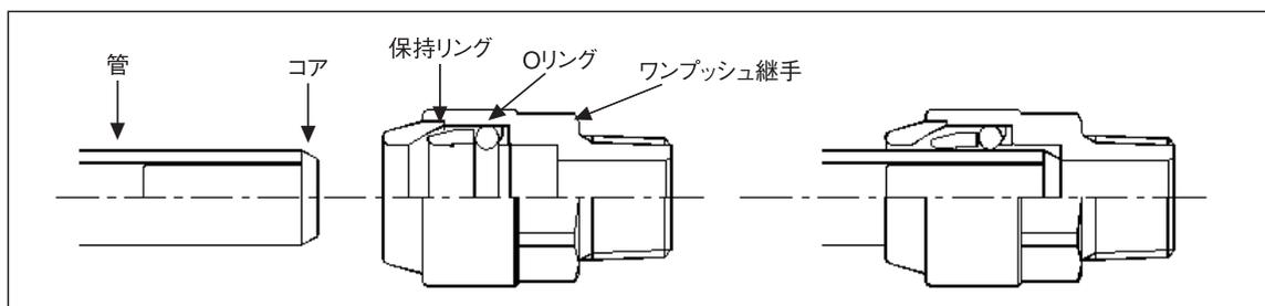
図 II-2-2 ワンプッシュ継手による接合
