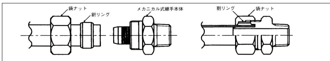
図 II-2-1 メカニカル継手による接合
