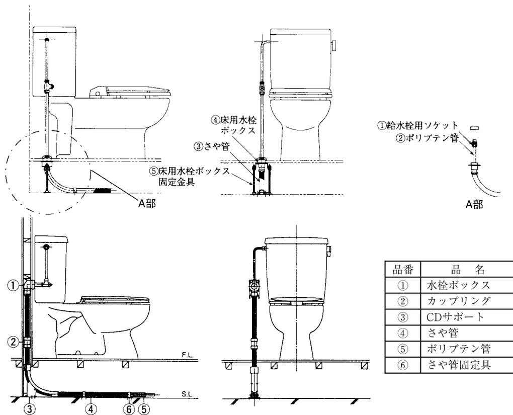
図 II-3-9 トイレの接続例（上：床立上げ 下：壁取出し）
