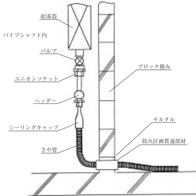
図 II -3-6 給湯器への接続例
