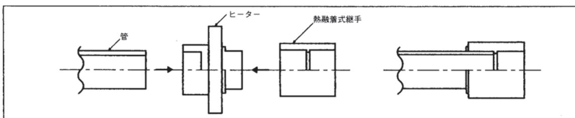
図 II -2-5 HF (ヒートフュージョン) 継手による接合
